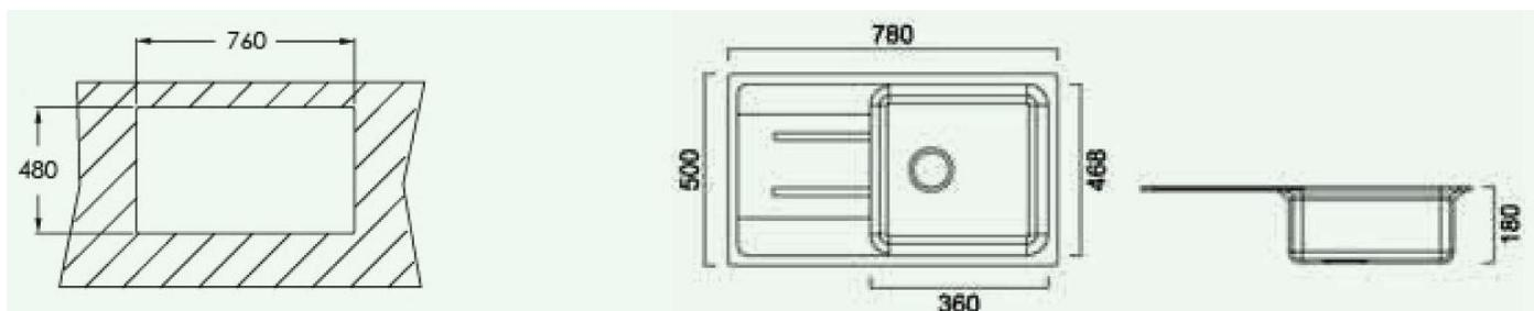
Длина мойки 780 мм, ширина 500 мм, диаметр отверстия под сифон 114 мм. Глубина корыта 180 мм.
