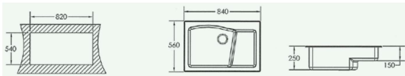
Длина мойки 840 мм, ширина 560 мм, диаметр отверстия под сифон 114 мм. Глубина корыта 250 мм. Глубина сушки-ступеньки 150 мм.
